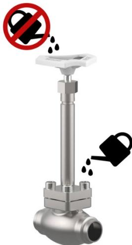
Um das Auftauen der Füllventile zu beschleunigen, kann das Gehäuse auch mit Wasser besprüht werden. Die Stopfbuchspackung ist vor Wasser zu schützen.
